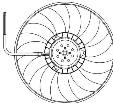
**Э/вентилятор кондиц. для а/м Audi A6 (C6) (04-) (без кожуха) (LFAC 1808)**
